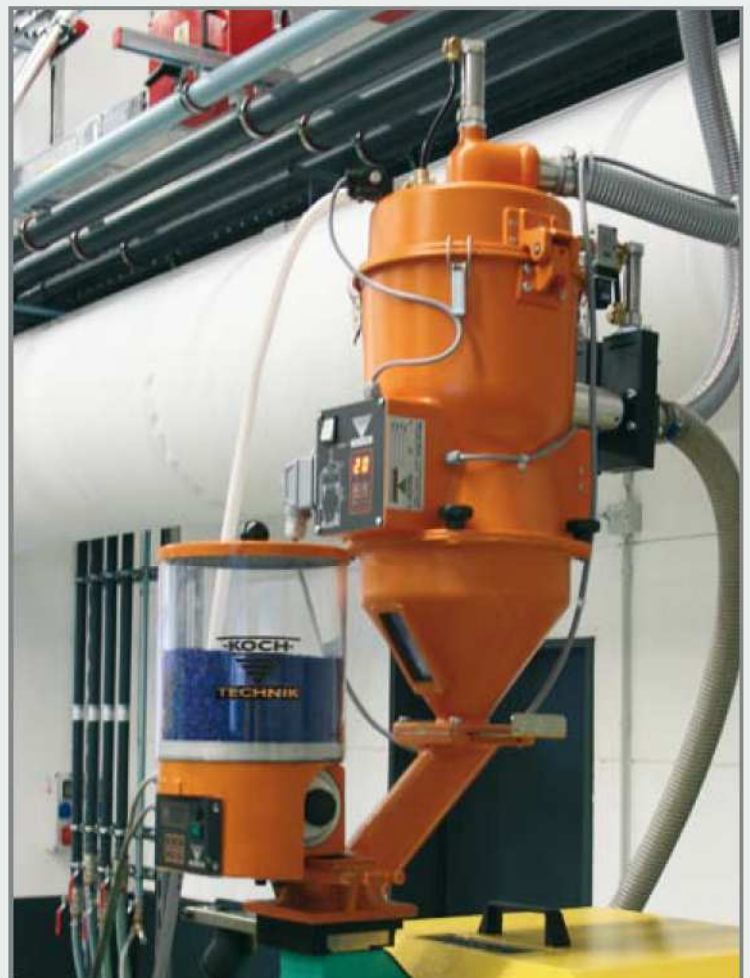
KEM, TmA 8, Z 5, AZ Flansch. Direkteinfärbgerät mit Zweikomponentenabscheider für Neuware und Mahlgut in einer Zentralförderanlage.
