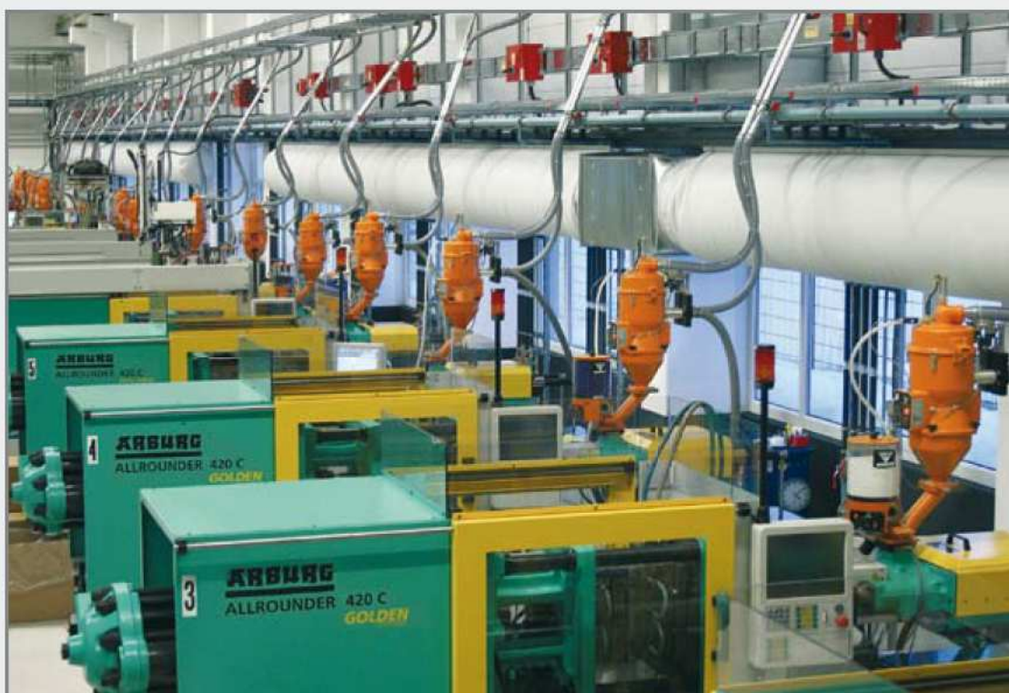
Fördergeräte in Kombination mit Direkteinfärbung in der Zentralförderanlage eines großen Verpackungsherstellers.
