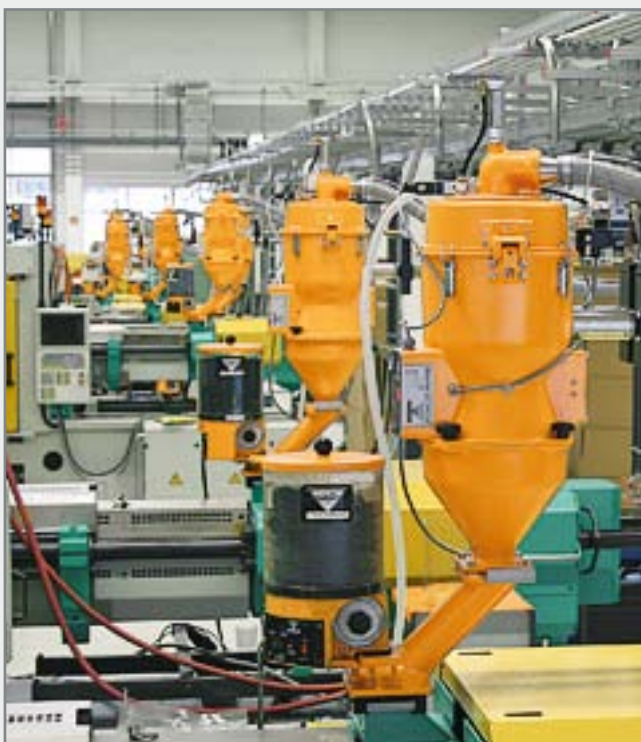
Typ KEM / AZ 3 / Z 5 Direktinfärbegerät mit Kammervolumendosierung für kleine und große Maschinendurchsätze.
