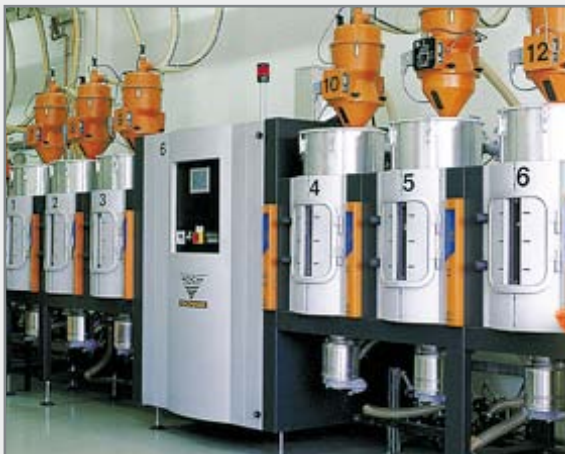
EKO 300 avec réservoir de stockage 6 x 100 litres
