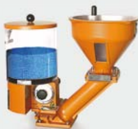
Modèle KEM / AZ 3 / Z 5 Un appareil de coloration directe avec dosage volumétrique par alvéole pour petits et gros débits machine.
