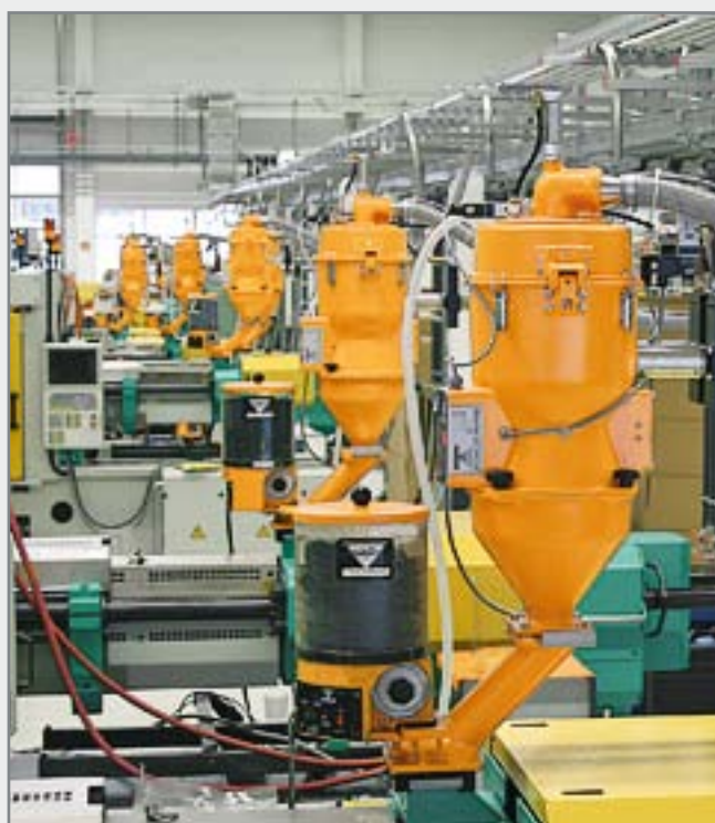
Modèle KEM / AZ 3 / Z 5 Un appareil de coloration directe avec dosage volumétrique par alvéole pour petits et gros débits machine.
