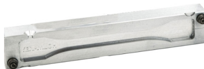
Moule d'éprouvette de traction
